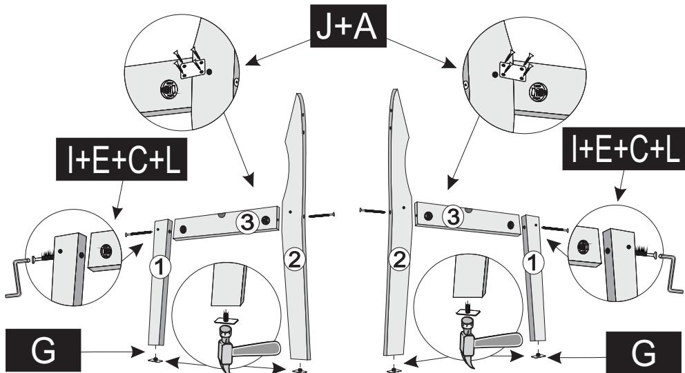
**2º** - UNIR O CONJUNTO LATERAL COM AS TRAVAS N.º4 E UTILIZANDO ANEL FIXADOR+PARAFUSOS 1/4X70 CAB. 13mm, FINALIZAR COM TAMPA FURO 13mm. POSICIONAR TRAVA CENTRAL N.º5.
