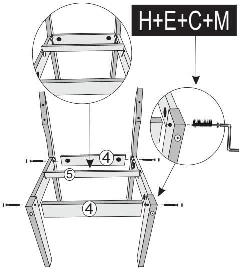
**4º** - UNIR ENCOSTO N.º6 COM OS PÉS N.º2 COM PARAF. 07X50 CAB. 13mm+CHAVE ALEN NA FURAÇÃO (B). EM SEGUITA, USAR PARAF. 07X70 CAB. 13mm NA FURAÇÃO (K)+CHAVE ALEN. COLOCAR TAMPA FURO 13mm.
