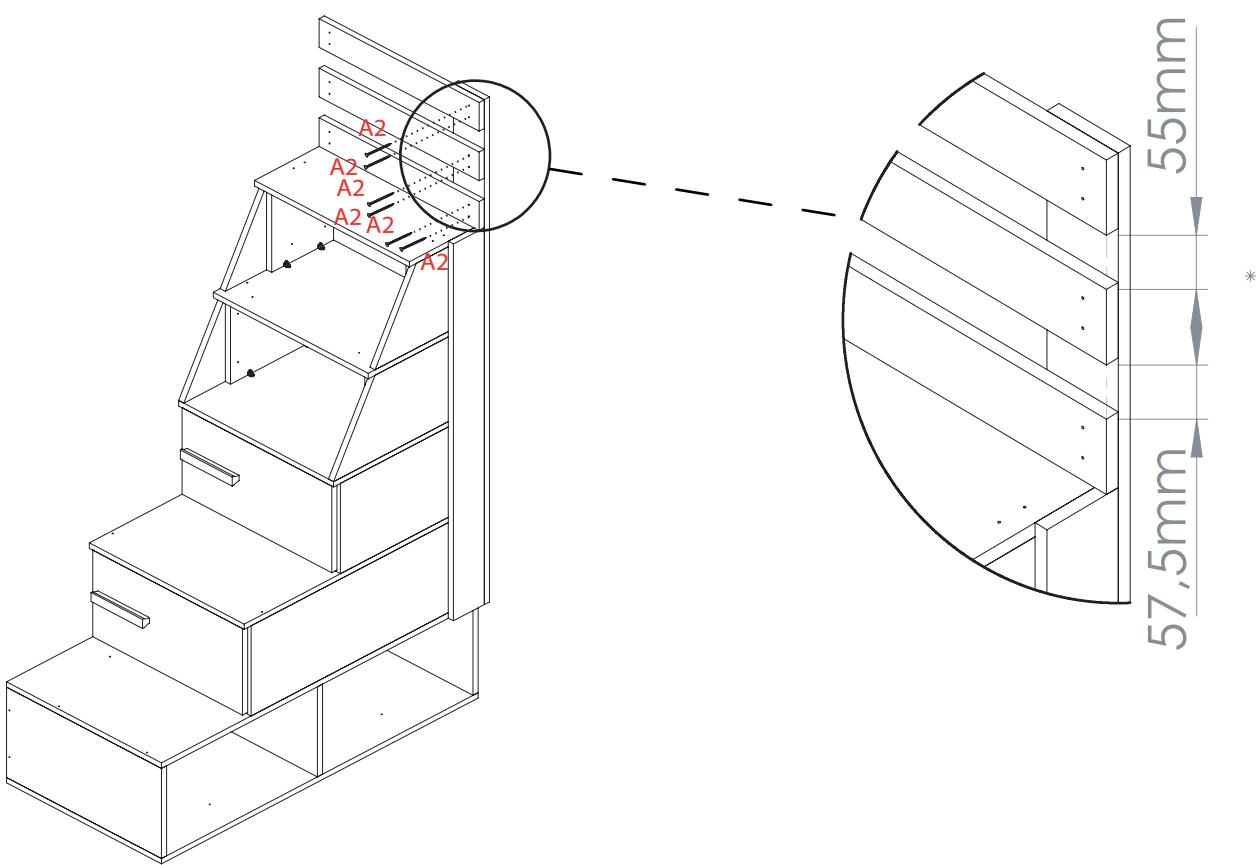
Posicione os nichos na escada, conforme indicado pelas setas no esquema de montagem.
