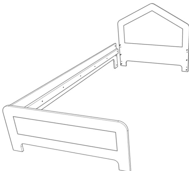
**PASSO 3:** Encaixe uma das estruturas formadas no passo anterior, nas peças 1 e 2, como demonstrado na imagem.
