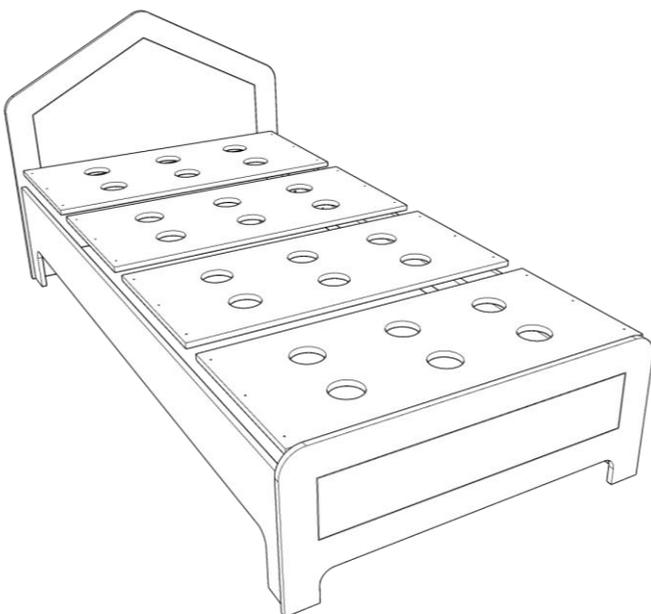
**PASSO 6:** Posteriormente, posicione as peças de número 6 com as furações voltadas para cima na estrutura, de modo que fiquem espaçadas entre si.
