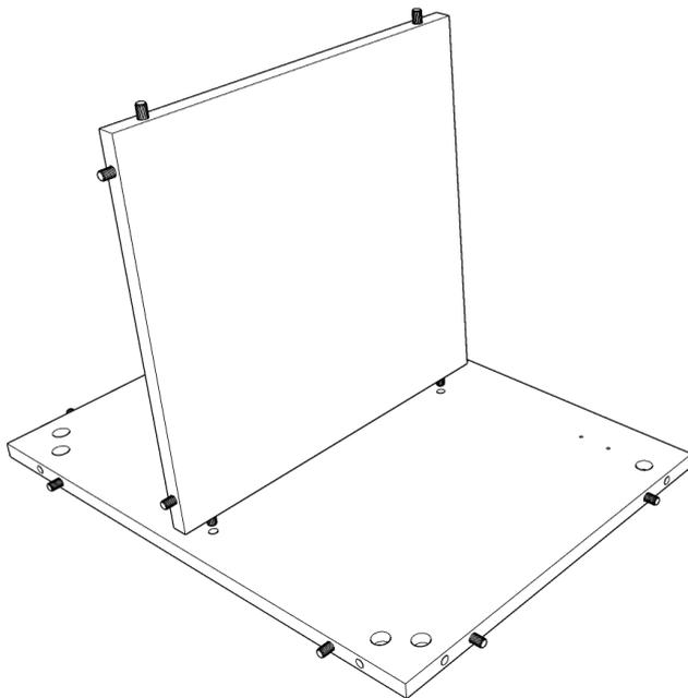
**PASSO 3:** Posteriormente coloque a peça de número 6 no chão com os furos voltados para cima, e encaixe a peça de número 5 no local demonstrado na imagem.
