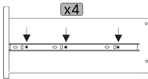
Fixação da parte móvel dos trilhos telescópico (T) nas gavetas com parafuso H.
