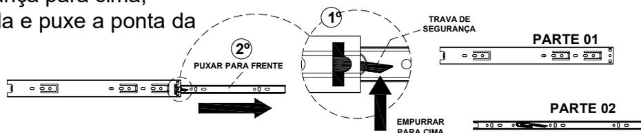
**15º** - Parafuse a parte **01** da corredeira (desenho abaixo) na lateral inferior direita e na divisão inferior direita, seguindo as marcações, usando **03 parafusos** Ch. Ph. 3,5x10 c/ pt. para cada corredeira.
