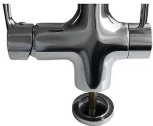
Coloque a base da torneira sobre a furação da bancada/cuba e depois encaixe a torneira por cima.
