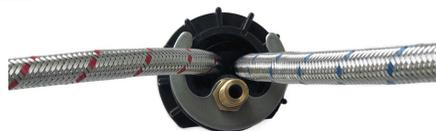
Dica: instale a mangueira azul, abra o monocomando na água fria, assopre pela mangueira e verifique se o ar passa pela torneira. Caso sim, a mangueira está instalada corretamente na entrada de água fria, caso não, inverta a entrada e teste novamente.
