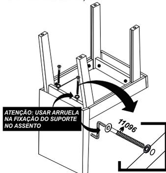
**8º-PASSO - PARAFUSAR AS CANTONEIRAS Cód.10388 NOS SUPORTES UTILIZANDO O (PARAFUSO 3,5X16 CABECA CHATA PHILLIPS Cód.25283) CONFORME ILUSTRAÇÃO.**
