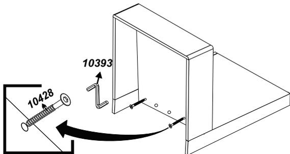
**6º-PASSO - PARAFUSAR A (CHAPINHA UNIÃO Cód.39787) NO ASSENTO NO ENCOSTO E UTILIZANDO O (PARAFUSO 3,5X16 CABECA CHATA PHILLIPS Cód.25283) O CONFORME ILUSTRAÇÃO.**
