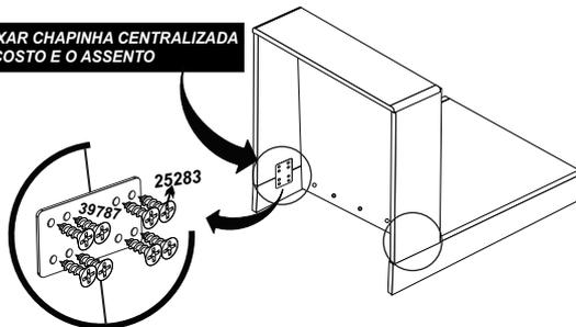
**7º-PASSO - PARAFUSAR O (SUPORTE TRASEIRO Cód.39782) NO ASSENTO (PARAFUSO 7,0X130 ESCARIADO Cód.11096) PRETO O CONFORME ILUSTRAÇÃO.**
