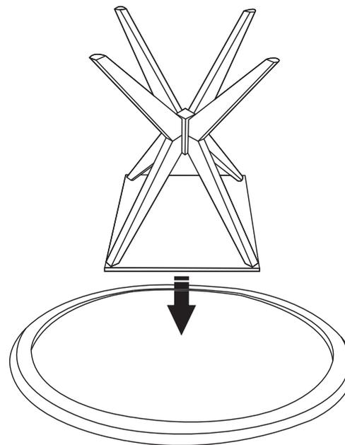
**03** Com o auxílio de uma parafusadeira faça a fixação de todos os parafusos da base no tampo
