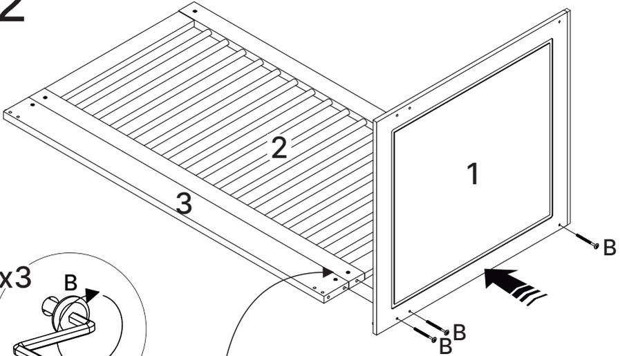
Se necessário alinhar porca cilíndrica com auxílio de uma chave de fenda
