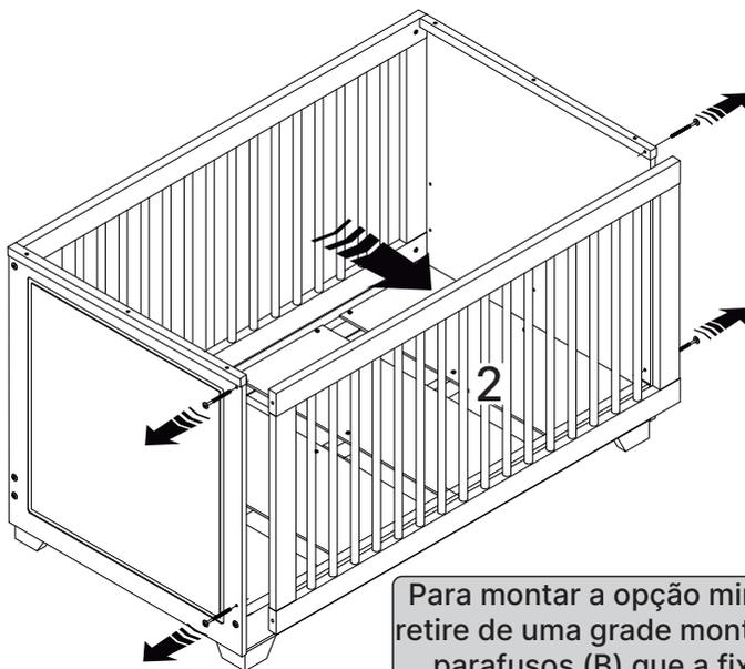
Para montar a opção mini cama, retire de uma grade montada os 4 parafusos (B) que a fixavam.
