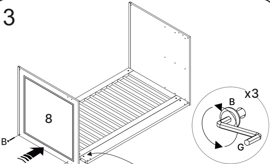
Se necessário alinhar porca cilíndrica com auxílio de uma chave de fenda
