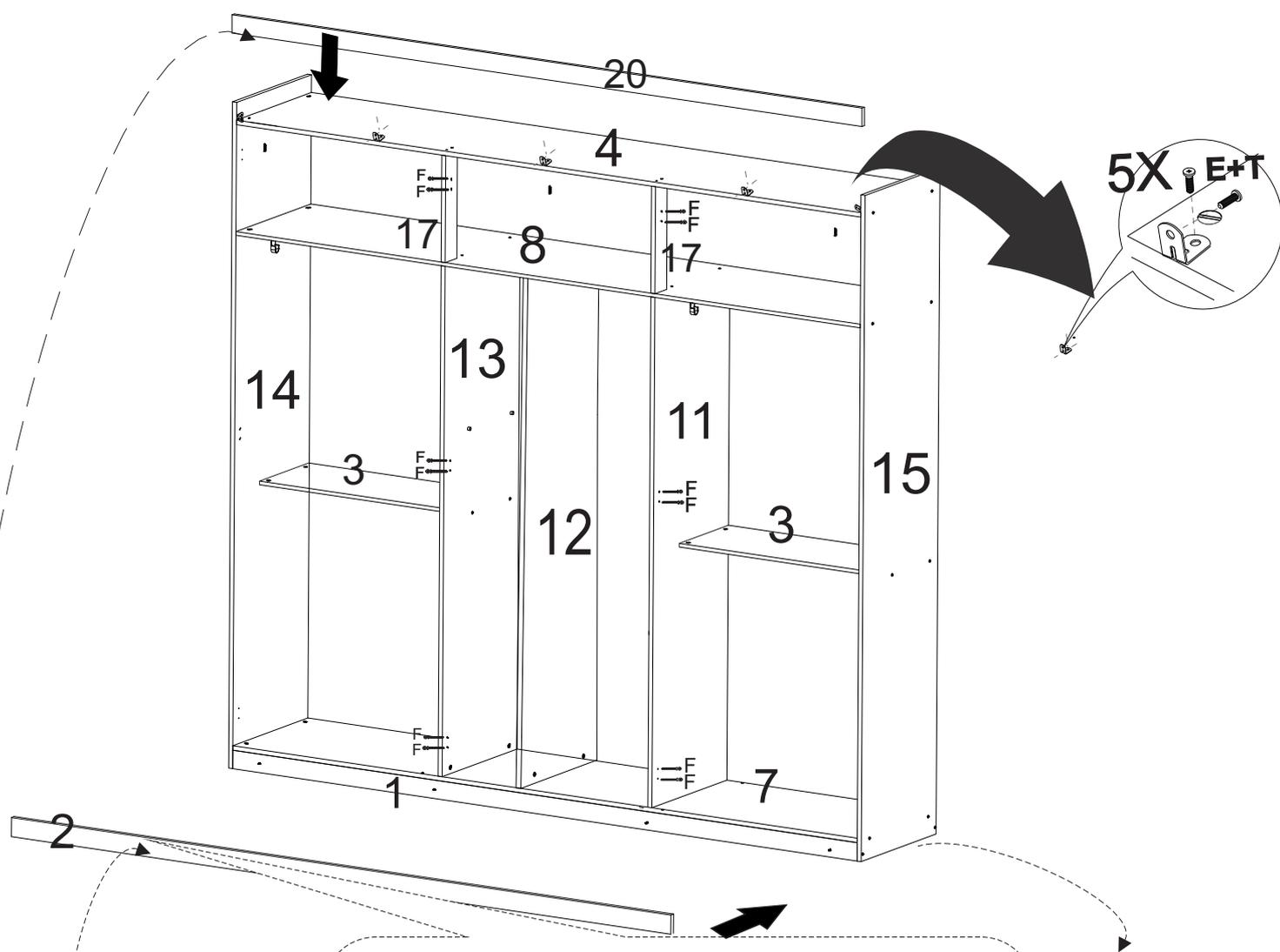
Fixar rodapé da frente no rodapé de dentro para fora com parafusos 3,5x25 mm sobrando 5 mm para cada lado
