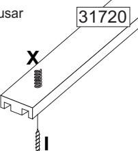
Encaixar as Molas (X) no trilho (31720) e parafusar de baixo para cima com o parafuso (I) no tampo (31706) de forma que o trilho fique flexível. A regulagem das portas são através do parafuso, folgue o parafuso ou aperte um pouco se necessário. Não aperte o parafuso até o final, a fim de que o trilho não fique encostado ao tampo, é necessário que trilho fique flexível para o encaixe e movimentação das portas.
