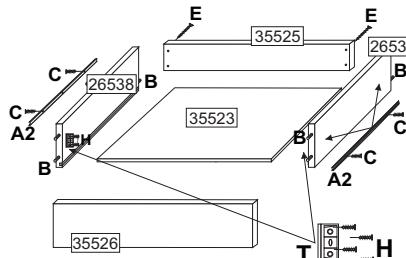
**Gavetas** - Parafusar as laterais de gaveta ao lenço da gaveta com o parafuso (E); encaixar o fundo no rasgo, fixe a frente com a cavilha (B) e cantoneira (T); a correida (A2) deve ser parafusada na lateral (26538) com o parafuso (C) na posição horizontal.
