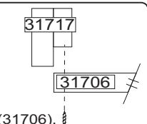
**Moldura** - Parafusar a moldura (31717) com parafuso (E) ao tampo (31706).
