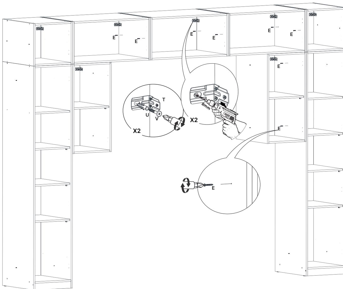
**! Atenção!! No Kit acompanha parafusos para fixação dos módulos entre si!**
