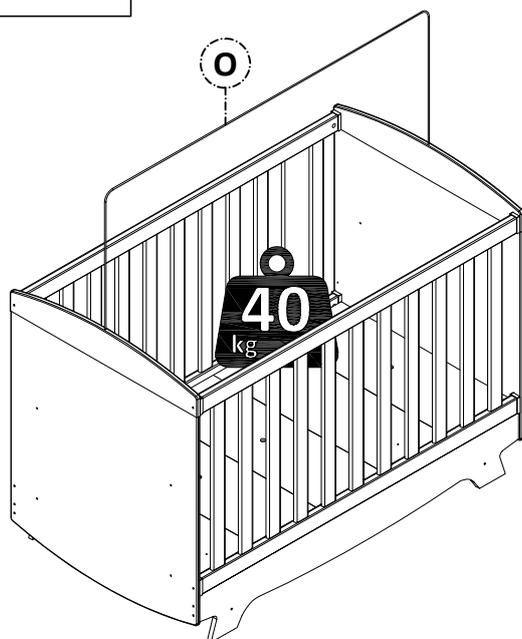
**Atenção:** Verifique se todas as conexões de montagem estão bem apertadas e se os mecanismos de travamento estão acionados antes de utilizar o berço.
