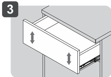
**.1** **Ajustar a gaveta e colocar os parafusos**
