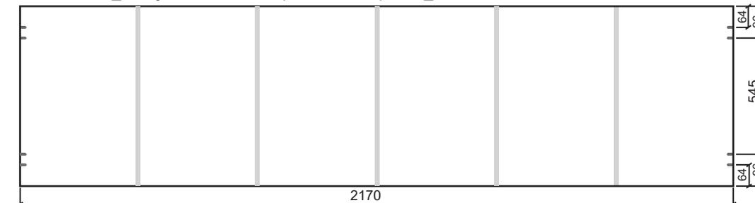
5. Divisória B\_Furação Face voltada p/ Lateral Direita\_2170X545X15mm
