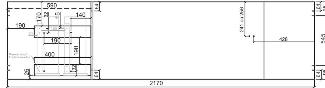
5. Divisória A\_Furação Face voltada p/ Lateral Direita\_2170X545X15mm
