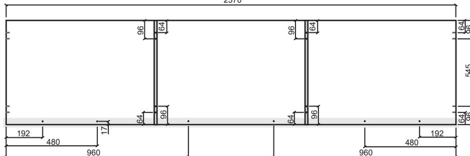
5. Divisória A\_Furação Face voltada p/ Lateral Esquerda\_2170X545X15mm
