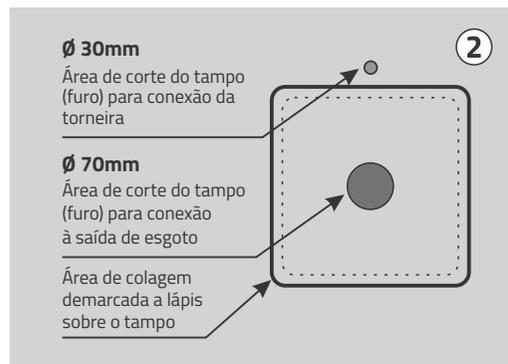
**1.** coloque a peça sobre o tampo na posição que se deseja instalar, considerando o alinhamento das torneiras e saída de esgoto. Marque no tampo onde será efetuada a saída de esgoto, como também o contorno da peça, verificando o paralelismo com a parede.
