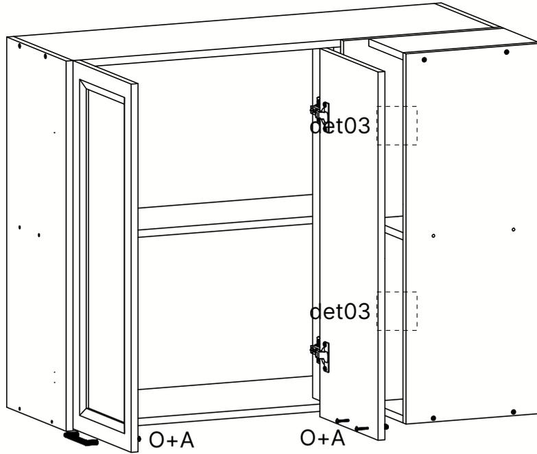
\*Use os parafusos (A) para unificar os módulos
