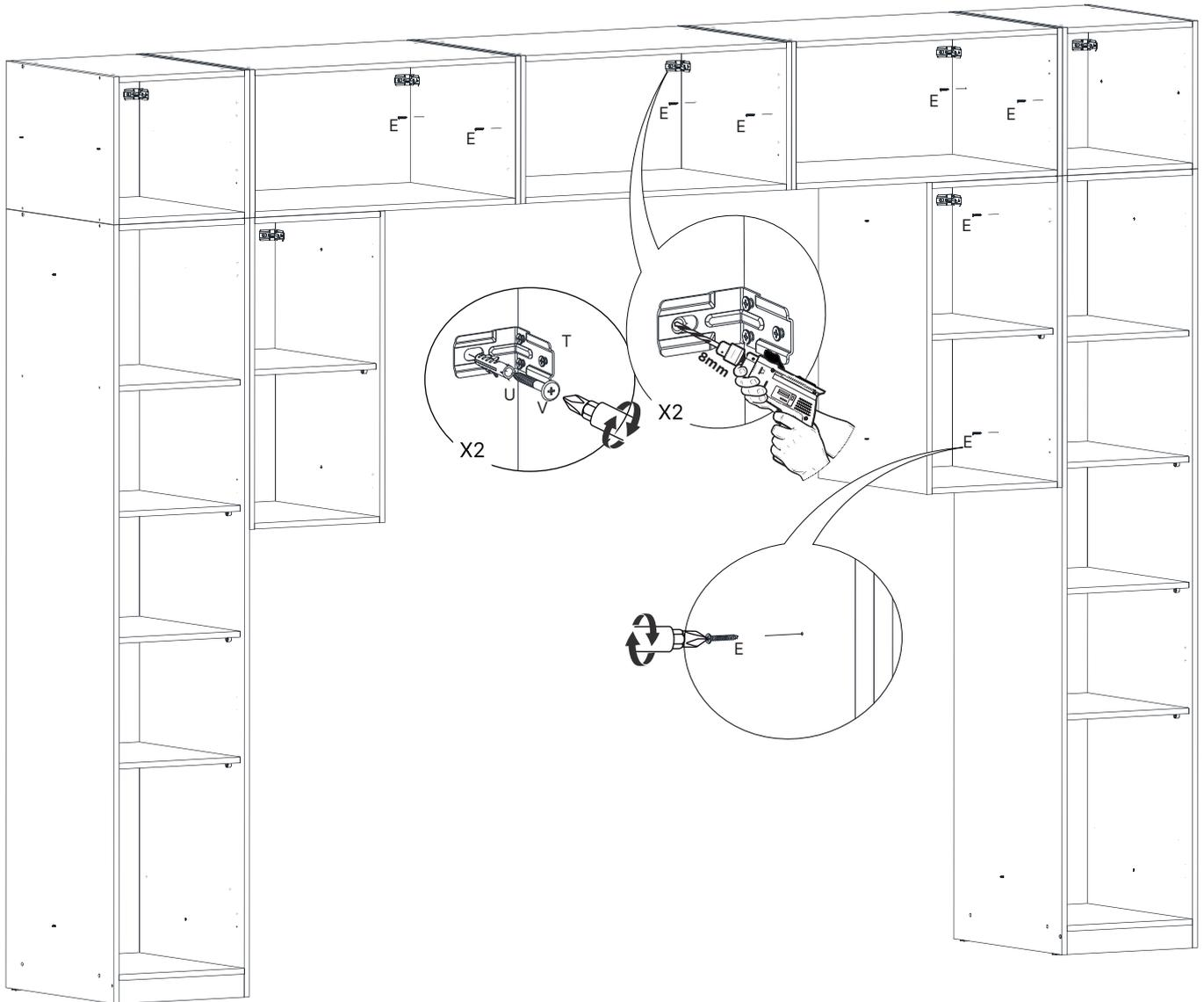
**⚠ Atenção!! No Kit acompanha parafusos para fixação dos módulos entre si!**
