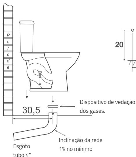
**Fig.1\_** Ponto de esgoto fica a 30,5 cm da parede acabada, com tubo de 4" (100 mm) de diâmetro.
