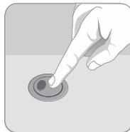
\_ O Mecanismo de saída com sistema de **Duplo Acionamento** possui ação independente para duas funções: **descarga total** e **descarga parcial**.
