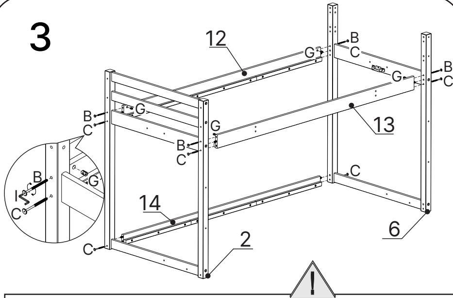
Não aperte os parafusos, porque você precisará de alguns movimentos para montar as peças no próximo passo.
