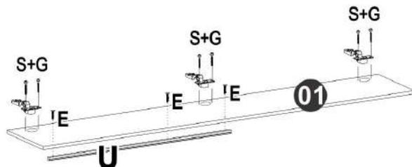
**OBS:** Fixar o Perfil Puxador com auxílio de uma chave Philips
