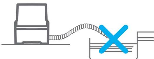
» **4.** Atenção a voltagem indicada na etiqueta do cabo de energia (127V ou 220V). Não utilize extensão ou adaptadores para tomada.
