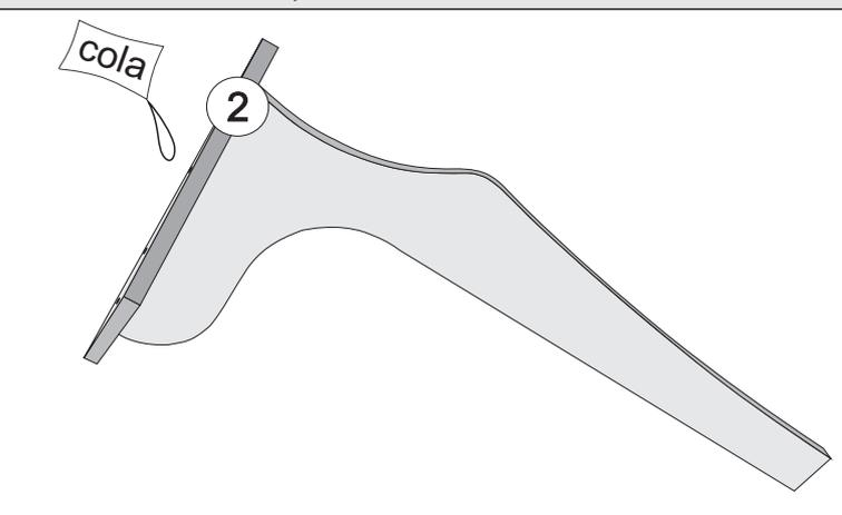
4º- APÓS A MONTAGEM DOS PÉS, USAR PARAFUSOS 3,0X20 PARA FIXAR AS SAPATAS PLANA NOS PÉS COMO ESTÁ ABAIXO. EM SEGUIDA POSICIONAR A PEÇA Nº2 NO TAMPO DIVIDINDO OS ESPAÇOS COM AS MEDIDAS ABAIXO E PARAFUSAR COM PARAFUSOS 4,0X25.
