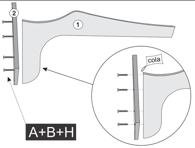
2º- CONTINUAR A MONTAGEM UTILIZANDO COLA NAS TRAVAS Nº3 E LATERAL Nº1 + PARAFUSOS 4,5x40 mm POSICIONANDO COMO ESTÁ ABAIXO:
