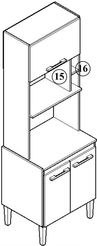
Fazer a fixação do pistão a gás na lateral, conforme indicação:
