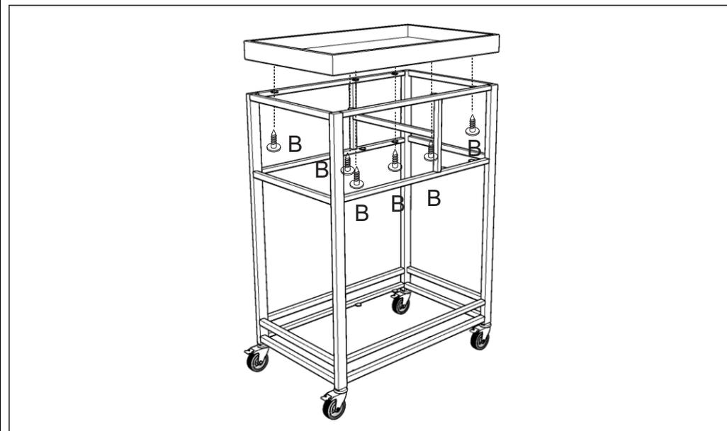
4) Com os parafusos 3,5x14 (B) fixe a prateleira inferior e a bandeja. Em seguida, fixe a adegna na parte inferior da bandeja.
