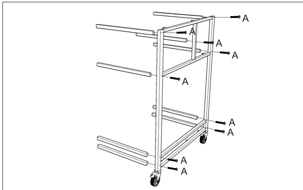
2) Insira o quadro direito e em seguida, faça a fixação com os parafusos 1/4x40 (A).
