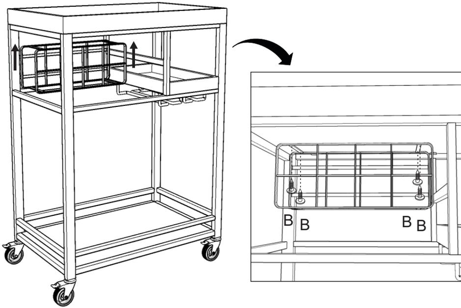
5) Para finalizar a montagem, fixe o puxador com os parafusos 3,5x14 (B).
