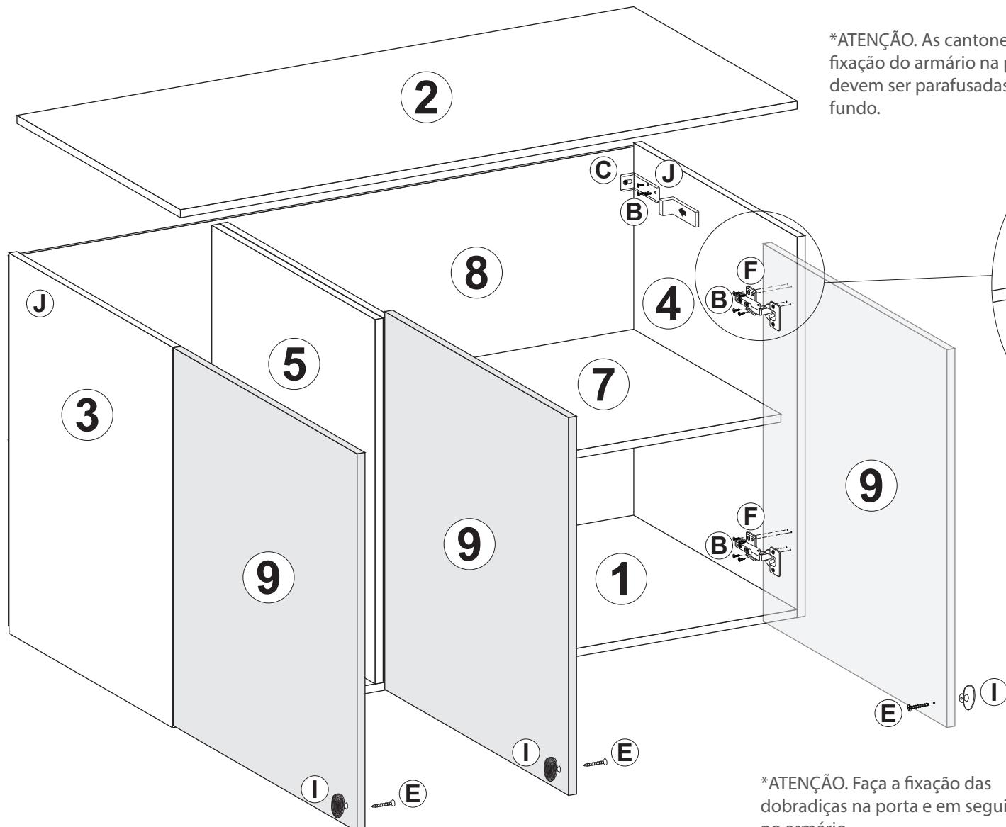
\*ATENÇÃO. As cantoneiras para fixação do armário na parede devem ser parafusadas na lateral e fundo.
