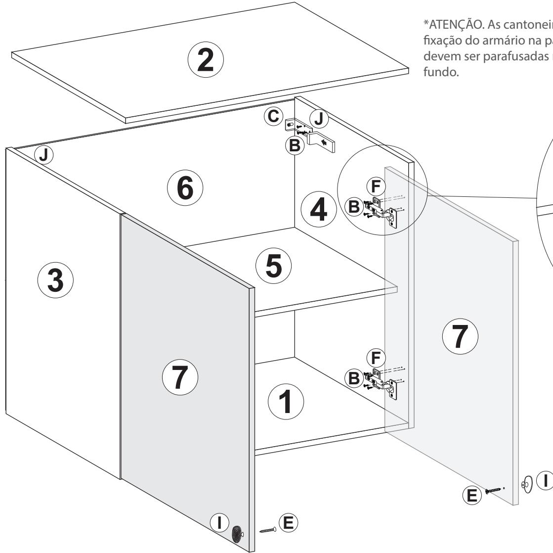
\*ATENÇÃO. As cantoneiras para fixação do armário na parede devem ser parafusadas na lateral e fundo.
