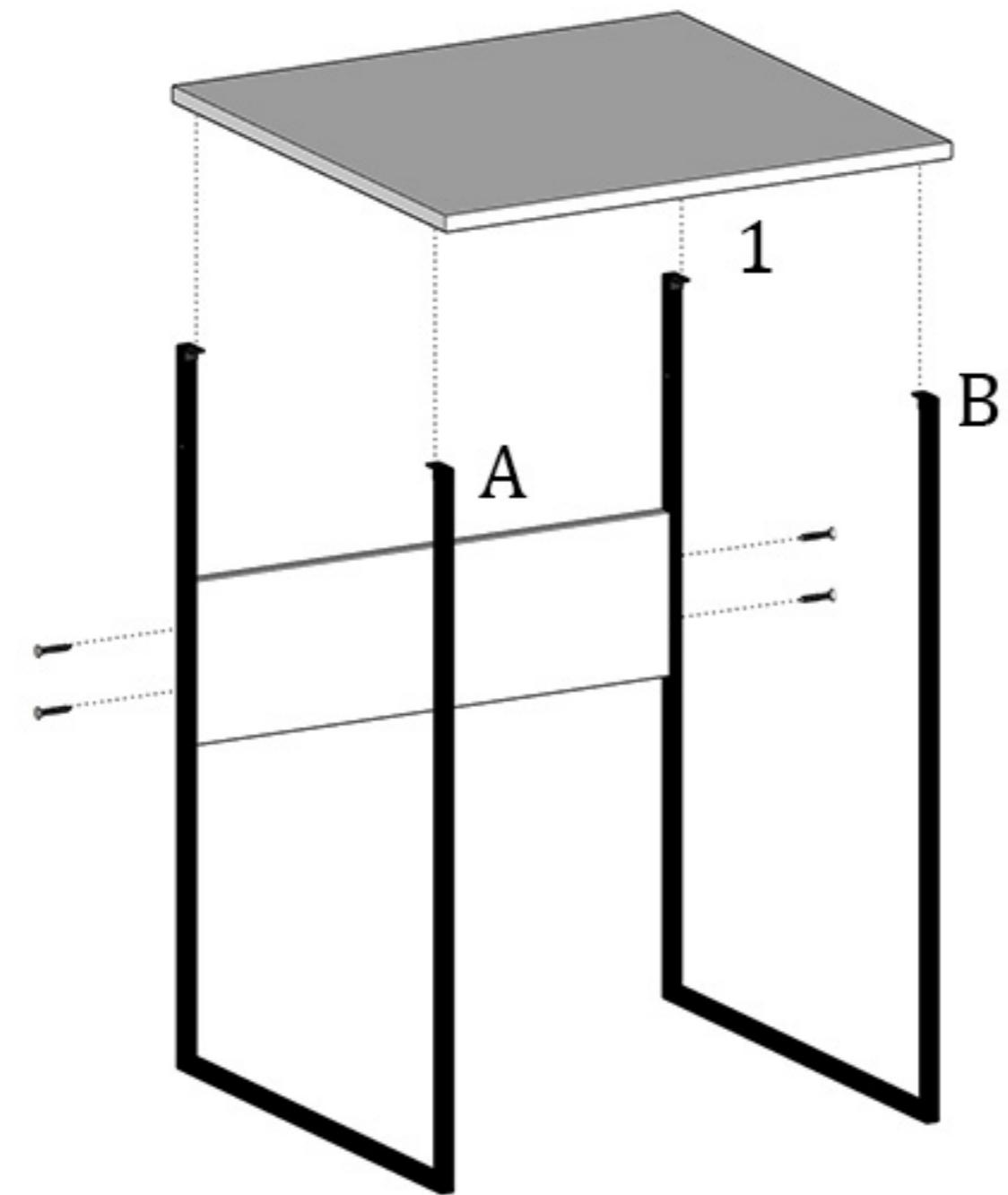
1- Unir as hastas com a ripa de travamento utilizando o parafuso longo e fixar o tampo superior.
