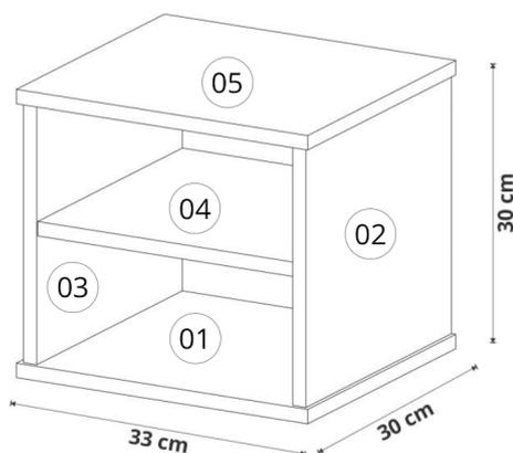
**1º PASSO:** Encaixe as cavilhas na peça 01, e em seguida encaixe as peças 02 e 03. Fixando-as com o Parafuso 4x40.
