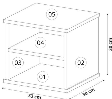
**1º PASSO:** Encaixe as cavilhas na peça 01, e em seguida encaixe as peças 02 e 03. Fixando-as com o Parafuso 4x40.
