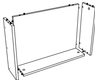
Encaixe a estrutura montada no passo anterior na peça 13 e repita o passo 7, colocando e fixando os tambores (AN). Repita este passo nas peças 11, 21, 24 e 25, para montar a outra gaveta:
