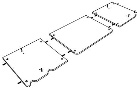
Com as cavilhas já colocadas nas peças 1 e 6, instale as corredeiras usando os parafusos (Y), como mostra a imagem:
