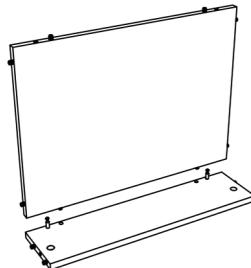
Encaixe as peça 23 nas peças 21 e 22, como mostra a imagem. Repita o passo 7, colocando e fixando os tambores (AN):
