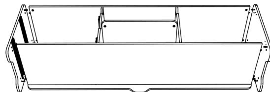
Inicie separando as peças 10, 21, 22 e 23 como mostra a imagem. Coloque as cavilhas de madeira (C) nas laterais das peças 21, 22 e 23. Em seguida coloque os parafusos (AN) nos furos menores das faces das peças 10, 21, 22 e 23. Repita este passo com as outras peças 11, 21, 24 e 25:
