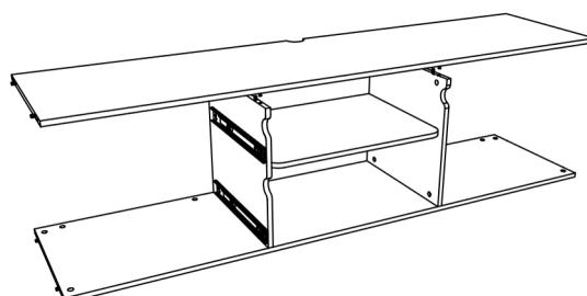
Encaixe a estrutura já montada na peça 5 e repita o passo 7 colocando e fixando os tambores (AN):
