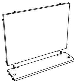
Encaixe as peça 23 nas peças 21 e 22, como mostra a imagem. Repita o passo 7, colocando e fixando os tambores (A):
