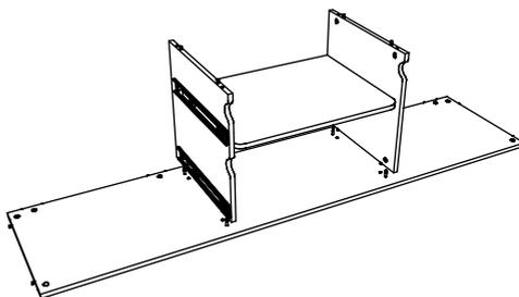
Repita o mesmo processo do passo 8 colocando a peça 4 nas peças 6 e 8 como mostra a imagem. Em seguida, repita o passo 7 colocando e fixando os tambores (A):
