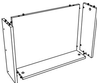
Encaixe a estrutura montada no passo anterior na peça 13 e repita o passo 7, colocando e fixando os tambores (A). Repita este passo nas peças 11, 21, 24 e 25, para montar a outra gaveta:
