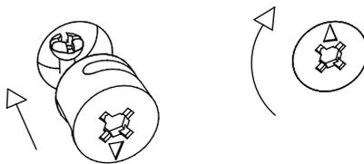
Com a peça 3 no chão, encaixe as peças já montadas no passo 6 na peça 3. Em seguida, repita o passo 7 colocando e fixando os tambores (A) nos furos inferiores das peças 6 e 8:
