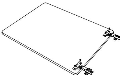
Parafuse a porta, peça 9, já com as dobradiças fixadas, na peça 2 usando os parafusos (E), como mostra a imagem:
