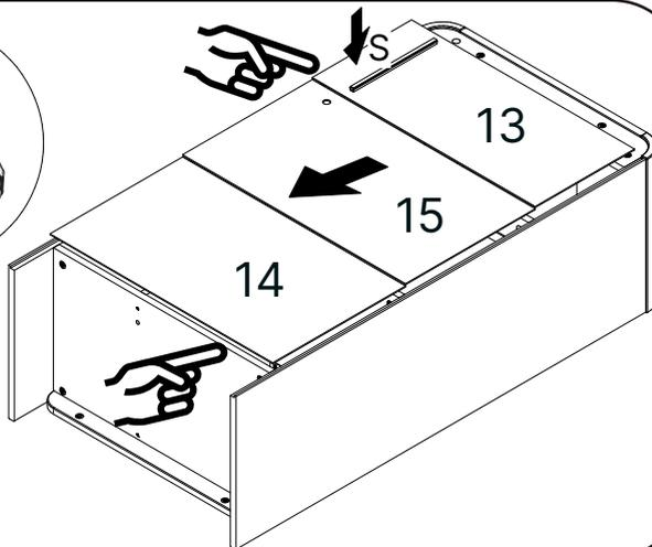
Remova a película de proteção da canaleta(S), e fixe-a na posição conforme acima:
