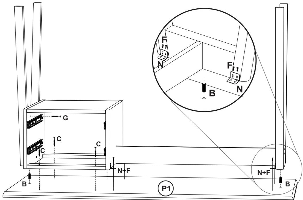
**8.** Montar as gavetas aplicando a cola nas furções onde serão colocadas as cavilhas.
