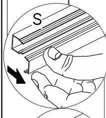
Desencaixar canaleta, passar fio e encaixar canaleta novamente.
