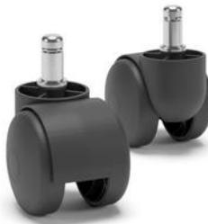
**Rodízio de PU:** Constituído de duas roldanas circulares, na dimensão de 50 mm de diâmetro, fabricadas em sua região central em poliamida (PA) e em sua banda de rodagem em poliuretano (PU), destinando – se a pisos rígidos.
