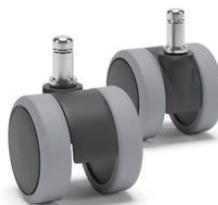
**Rodízio de PA:** Constituído de duas roldanas circulares, na dimensão de 50 mm de diâmetro, fabricadas em sua região central e em sua banda de rodagem em poliamida (PA) destinando – se a pisos carpetados.
