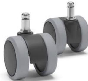
**Rodízio de PA:** Constituído de duas roldanas circulares, na dimensão de 65 mm de diâmetro, fabricadas em sua região central e em sua banda de rodagem em poliamida (PA) **destinando – se a pisos carpetados.**
