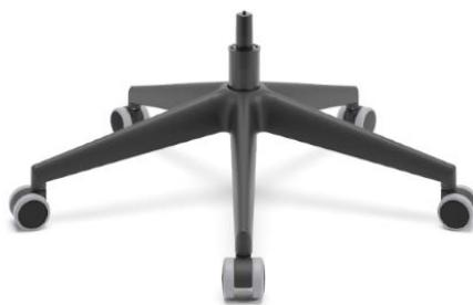
**Base Aço Cromado:** Constituída com cinco pás de apoio para fixação dos rodízios e uma furação central conificada para acoplamento da coluna a gás, obtendo um diâmetro na ordem de 700 mm. As pás de apoio são fabricadas em chapa de aço carbono, conformadas pelo processo de estampagem e travadas por soldagem MIG. O anel central é fabricado em tubo de aço carbono, onde as pás são fixadas a este pelo processo de soldagem MIG.
