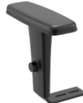
**Braço Regulável:** Apoio de braço com regulagem de altura, que se dá pelo pressionamento de um botão na parte frontal do apoio de braço. Possui 70 mm de curso para a regulagem de altura, dispostos em oito posições definidas.
