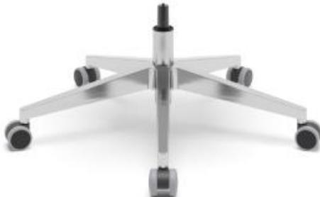
**Base Itália:** Constituída com cinco pás de apoio para fixação dos rodízios e uma furação central conificada para acoplamento da coluna a gás, obtendo um diâmetro na ordem de 690 mm. O conjunto é fabricado pelo processo de injeção de termoplástico em poliamida aditivada com de fibra de vidro.
