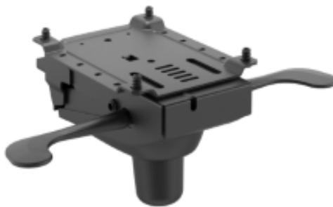
**Autocompensador:** Fabricado em aço com corpo predominantemente desenvolvido em chapas de 3 mm de espessura. O mecanismo recebe uma proteção de preparação de superfície metálica e revestimento eletroestático epóxi em pó, que garante proteção e maior vida útil ao produto.
