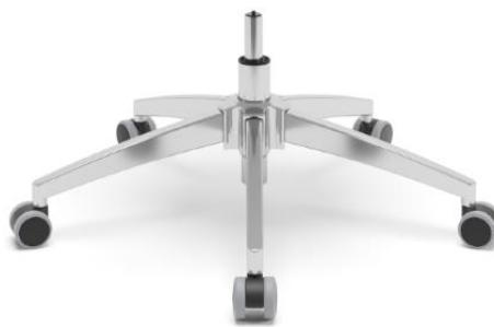
**Base Standard Diretor:** Constituída com cinco pás de apoio para fixação dos rodízios e uma furação central conificada para acoplamento da coluna a gás, obtendo um diâmetro na ordem de 680 mm. As pás de apoio são fabricadas em chapa de aço carbono, conformadas pelo processo de estampagem e travadas por soldagem MIG, formando um perfil de secção 26 x 26,5 mm. O anel central é fabricado em tubo de aço carbono, onde as pás são fixadas a este pelo processo de soldagem MIG.
