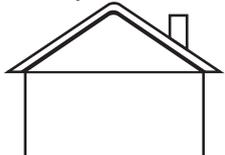
Chaminé sem altura, diâmetro inadequado e sem chapéu, ocasionado má exaustão da fumaça.
