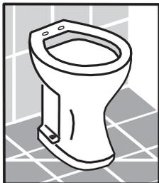
5 - Coloque arruelas e porcas apertando até perfeita fixação para nivelamento utilize nível
