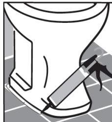
7 - Agora iremos efetuar a instalação da caixa acoplada na bacia sanitária. Devemos acoplar a bolsa de vedação na saída de água da valvula.
