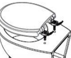
10 - Abra a tampa dos fixadores, encaixe a bucha (1) no fixador (2) e a guarnição anti-deslizante (3) por baixo. Conforme figura abaixo
