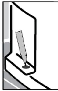
3 - Retire a bacia, neste momento iremos utilizar a furadeira com broca de 10 mm. Em seguida coloque as buchas no furo e anel de vedação na entrada do esgoto.
