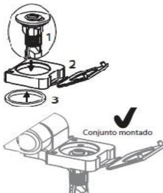
11 - Pressione o conjunto de bucha expansora com uma chave Philips / Fenda no furo da bacia, até encaixar totalmente não gire o parafuso ainda.
