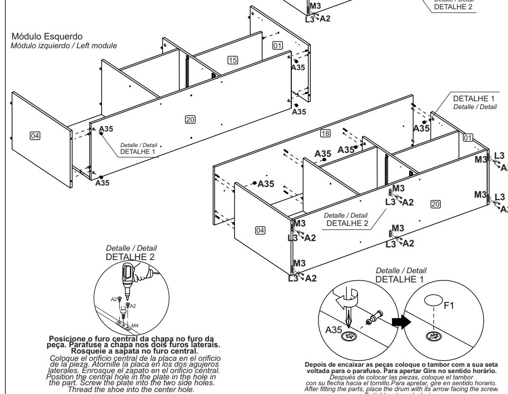
Posicione o furo central da chapa no furo da peça. Parafuse a chapa nos dois furos laterais. Rosqueie a sapata no furo central.
