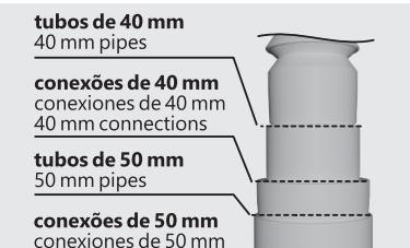
Instale o sifão sanfonado na válvula com o adaptador, conforme sequência ao lado, apertando manualmente de forma a garantir a vedação.
