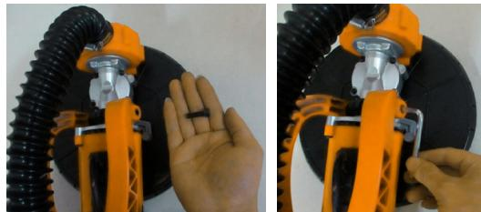
3. Instalação do tubo telescópico (insira o tubo telescópico no tubo frontal, ajuste o comprimento adequado, gire a porca de travamento no tubo plástico frontal e trave.)
