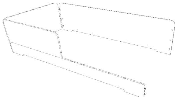
**PASSO 6:** No outro lado da peça 1, encaixe a peça 4 no local indicado na imagem. E repita o passo 3, colocando e fixando os tambores (AN) nos furos que se localizam na peça 4.
