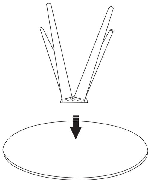
**04** Com o auxílio de uma parafusadeira faça a fixação de todos os parafusos da base no tampo
