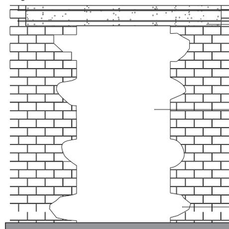
Viga de sustentação de alvenaria com armadura de aço sobre a esquadria.
