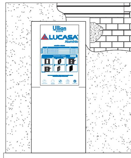
Ao rebocar as paredes, cuidado para não respingar reboco na esquadria. Caso ocorra, limpe rapidamente com pano úmido antes que o reboco endureça.
