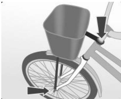
**Cestas:** A cesta deve ser fixada no suporte anexado na parte frontal do movimento de direção, com os parafusos e porcas fornecidos com o Kit. Caso a cesta acompanhe uma haste, a mesma deverá ser fixada no suporte frontal juntamente com o eixo da roda e paralama.
