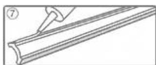
Sempre verifique se as peças (canto e perfis) se encaixam, colocando-os sobre as marcações da parede ainda sem o selante Graddus Fix. Se necessário use o estilete para ajustar os cortes nas molduras.
