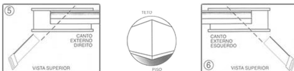
Pegue dois pedaços da moldura. Posicione-os contra a parede e o teto. Pegue o pedaço da esquerda e ponha de cabeça para baixo na caixa de corte (lembre-se que a base da caixa de corte é o teto e a lateral, a parede). Corte a moldura com a serra de fita direcionada para o lado direito (fig.5). Em seguida, pegue o pedaço da direita e ponha de cabeça para baixo na caixa de corte. Corte a moldura com a serra de fita direcionada para o lado esquerdo (fig.6).
