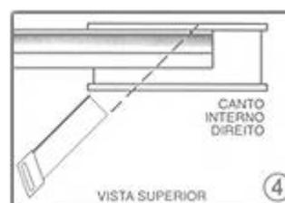
Pegue dois pedaços da moldura. Posicione-os contra a parede e o teto. Pegue o pedaço da esquerda e ponha de cabeça para baixo na caixa de corte (lembre-se que a base da caixa de corte é o teto e a lateral, a parede). Corte a moldura com a serra de fita direcionada para o lado esquerdo (fig.3). Em seguida, pegue o pedaço da direita e ponha de cabeça para baixo na caixa de corte. Corte a moldura com a serra de fita direcionada para o lado direito (fig.4.).
