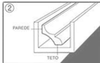
Pegue uma barra da moldura e a posicione contra a parede e o teto a fim de marcar a linha guia para a instalação (fig.1.) Posicione a moldura na caixa de corte, como
