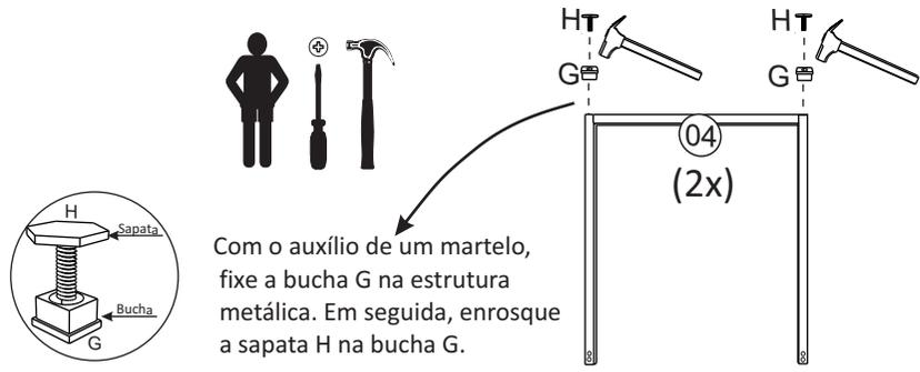
Com o auxílio de um martelo, fixe a bucha G na estrutura metálica. Em seguida, enrosque a sapata H na bucha G.
