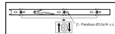
**Espaço livre na horizontal:** Retire a gaveta, desparafuse a corrediça na lateral do móvel, regule conforme a necessidade e parafuse novamente. Coloque novamente a gaveta no móvel, caso a folga esteja correta favor retirar a novamente a gaveta e aplicar mais (um) parafuso na corrediça, usando o furo fixo conforme desenho.
