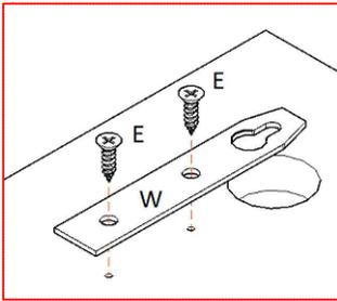
**2.** Fixe as buchas 6 mm na parede nos pontos onde a espelheira será fixa. Estes pontos são dados tomando como referência o gabarito para furação. Para este modelo a posição para furação é "A". Introduza um parafuso 4x40mm em cada uma das buchas, deixando em torno de 2 milímetros do parafuso para fora. O armário possui chapas metálicas na parte traseira para que seja possível pendurá-lo.
